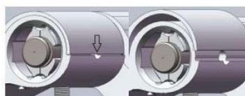
S využitím technologického otvoru nadzvedněte maskovací kryt plochým šroubovákem, abyste získali přístup k nastavování
